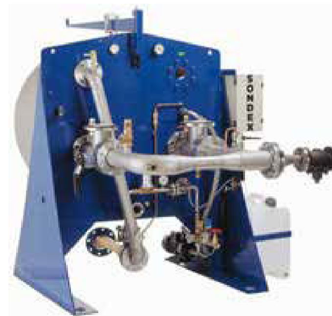
Generador de agua dulce
